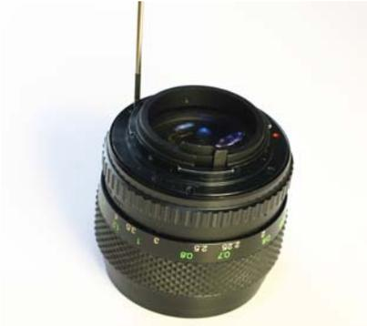
Zunächst wird die rückseitige Objektivabdeckung, bzw. das Bajonett abgeschraubt.
