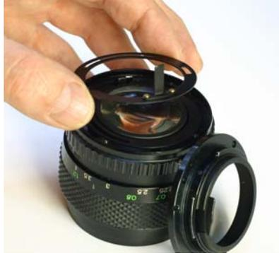
Dann wird der Ring mit dem Blendenübertragungsstab entfernt.
